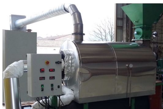
Le CarboChar-1 est le plus petit modèle des machines de production de biochar développées par Pro-Natura.
