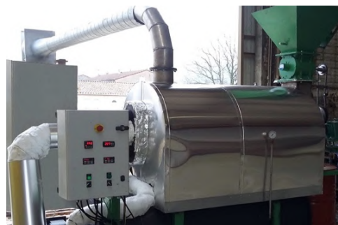
Le CarboChar-1, machine de pyrolyse pour la production de biochar
